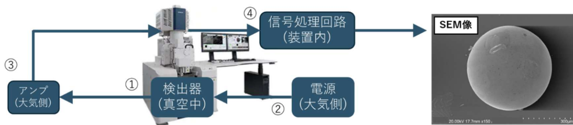
図 40 SU7000 で倒立型検出器を動作させるためのセットアップ
