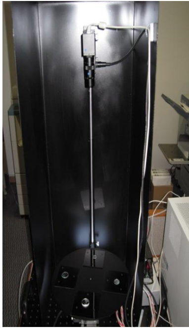
図 5-6 改造型レンズ傷検査装置の外観（左側）及び回転ステージ上のレンズ（右側）
