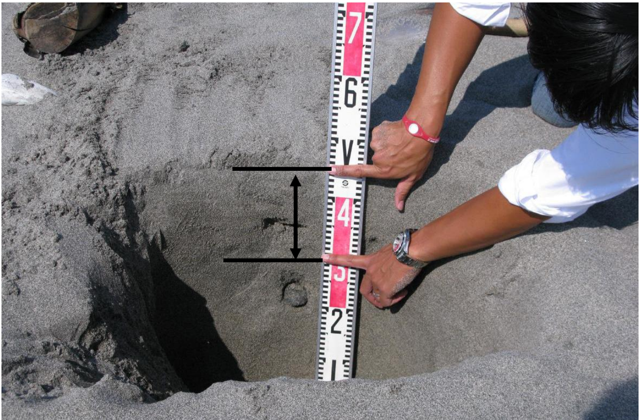
図4-30 矢印の先から始まる下層は上層と比べて黒くなっている。境界面の写真
