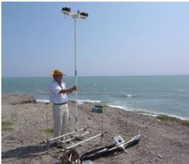
図 4-20 可搬式定点撮影システム
