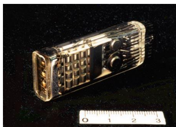
図 2-2-2-1 4 連角型光電子増倍管(R3309)外観
