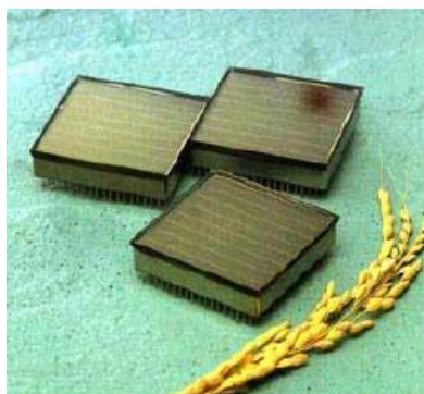
図 2-2-7-1 52mm 角フラットパネル PS-PMT(R8400-00-M64)の外観
