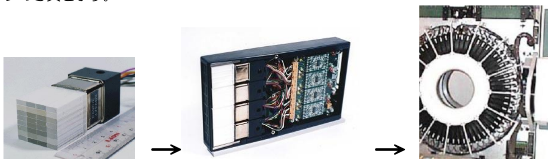
図 2-2-4-2 位置検出型メタルパッケージ 28mm 角型光電子増倍管(R5900-C8)と 8×4 に配列された BGO クリスタル検出器ユニット→検出器モジュール→検出器リングの外観
