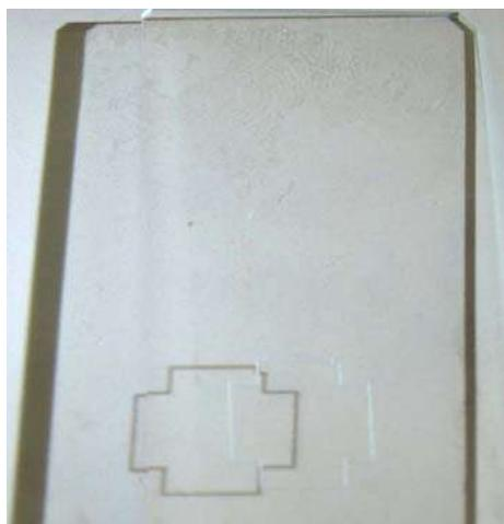
図8-42. ガラス表面の傷検査
