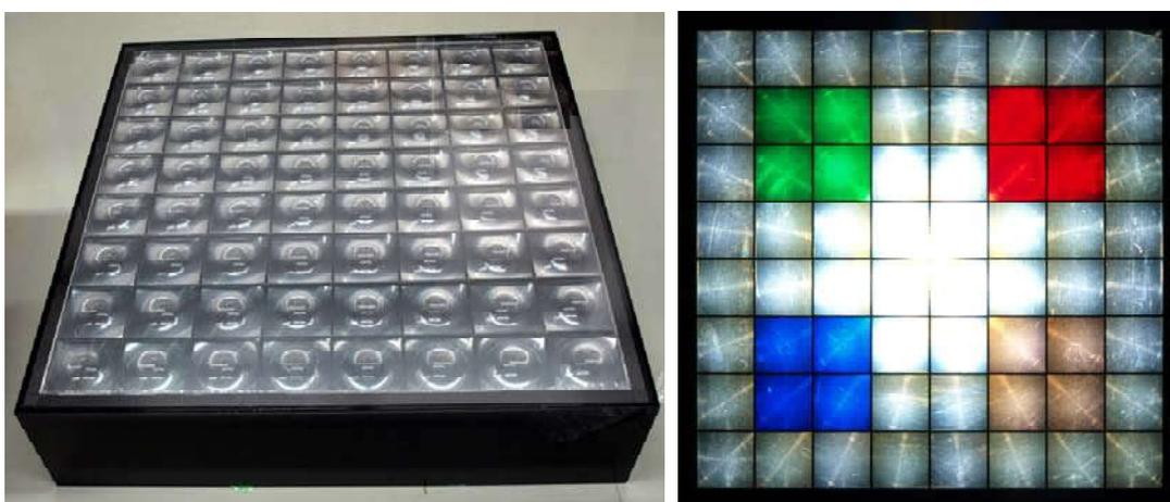
図8-50. 64個並列接続型ホロライト（左：概観写真 右：照明時）
