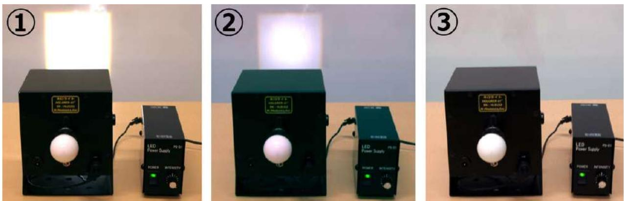
図8-33. 光量可変型ホロライト (①光量最大 ②光量中間 ③光量最小)
