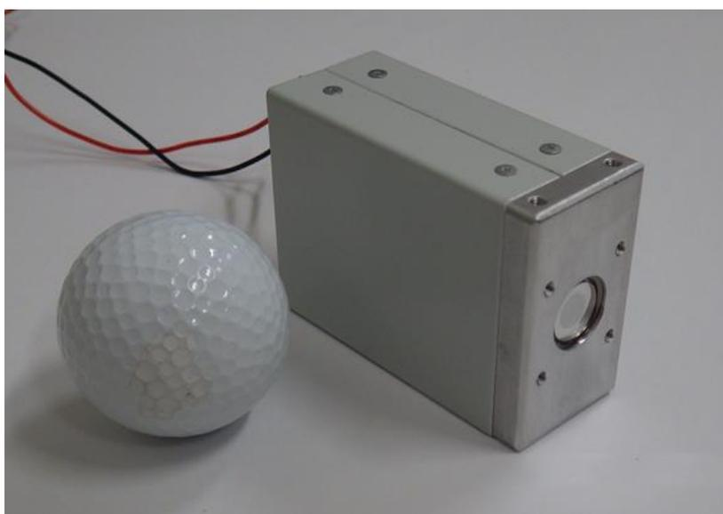
図 5-20 冷陰極光源を搭載したデバイス
