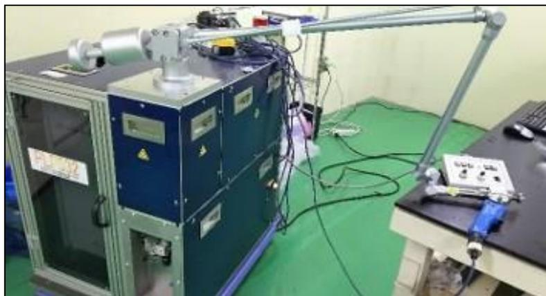
写真 5-1 レーザーピーニング装置 出所：大建産業（株）HP
