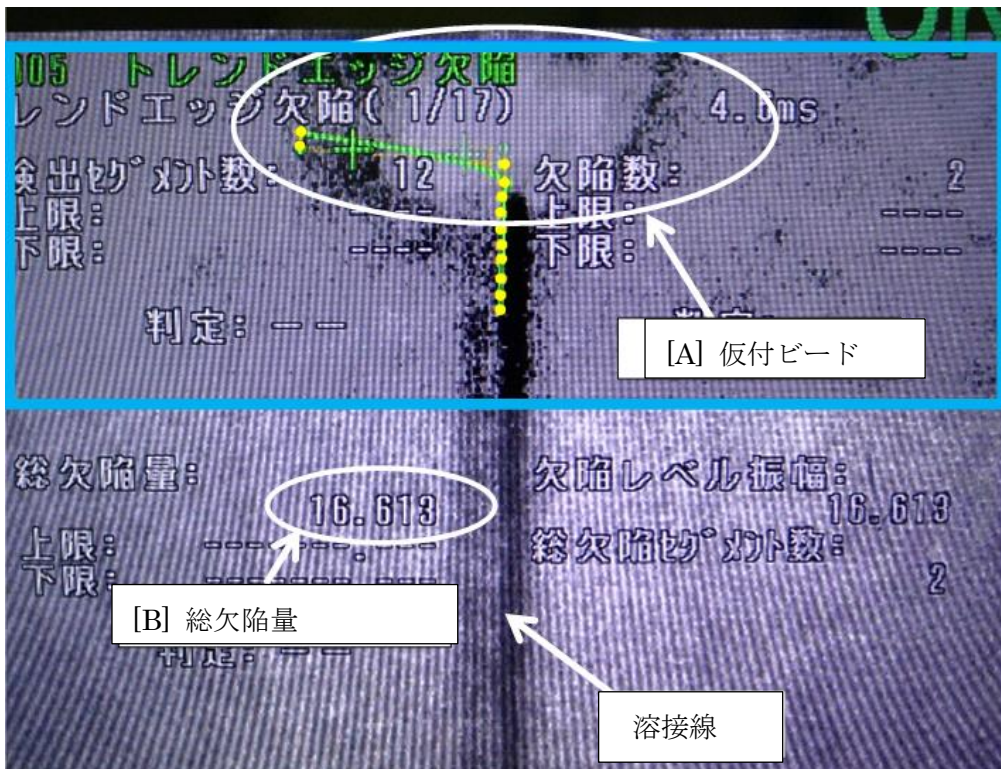
図6-3：仮付ビードがある場合の画像処理データに示されたトレンドエッジの欠陥量
