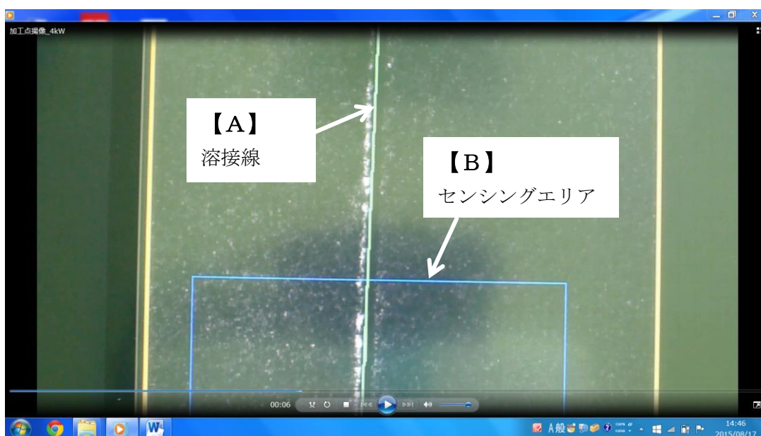
図3-5：溶接ラインの自動認識（溶接線A＝緑色の縦の仮想線）
