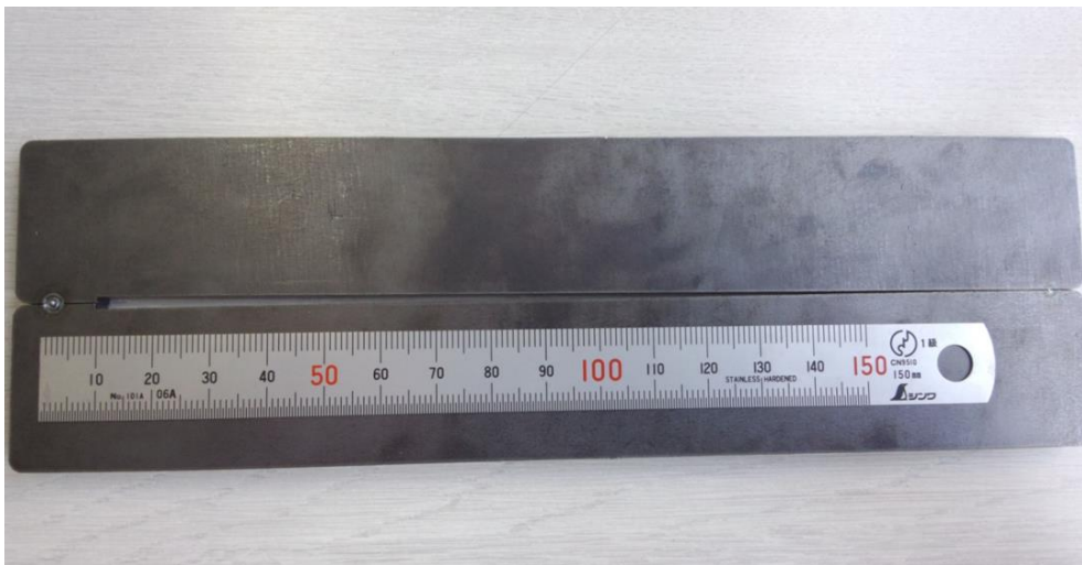
図5-6：溶接前の継手形状
