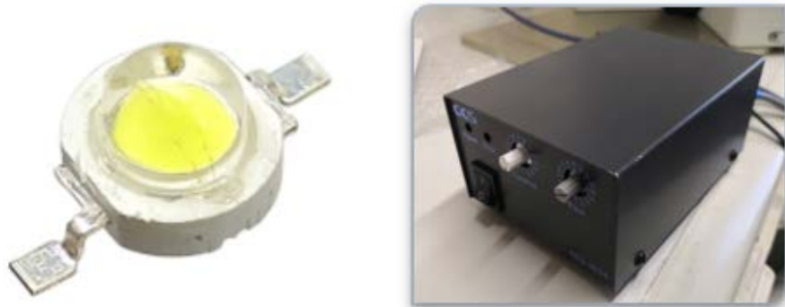
図 3-29 搭載した高輝度 LED と電源装置.
