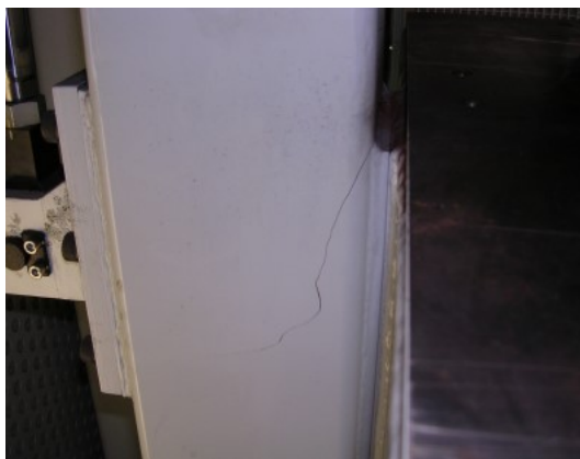
図 22 溶接 HAZ 部からのひび割れ(2)
