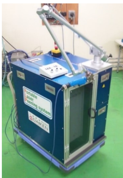
図 24 レーザーピーニング（PLP532）装置 1年目本体と中空アーム
