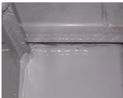
図 21 溶接 HAZ 部からのひび割れ (1)
