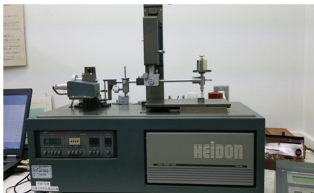
図 42 摩擦係数測定機（浜松工業技術支援センター）
