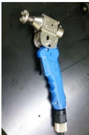
図 25 レーザーピーニング (PLP532) 装置 1 年目ヘッド部
