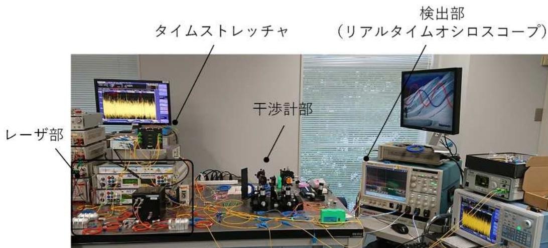
図 4-1 TS-LCI 測定システムの外観写真
