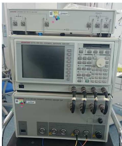
図 4-9 使用した波長分散分析装置
