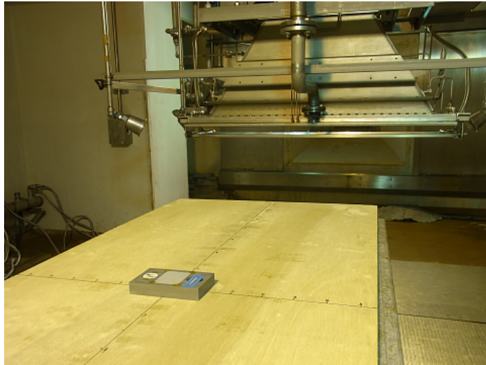
図 4.5 線量計フォルダーへの 2 MeV 電子線照射
