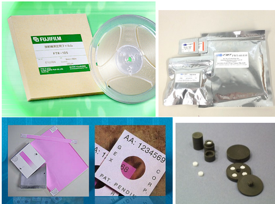
図 3.1 電子線線量測定に用いられている線量計の例 左上：富士フィルム社製アラニン線量計 FTR-125 [8]、右上：FWT 社製 FWT-60[9]、左下：GEX 社製 B3 線量計 [10]、右下：NPL アラニン線量計 [11]
