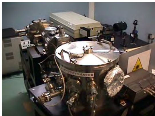
図 2.3. 製品化したレーザー生成プラズマ光源装置。高分子フィルムとアルミニウムなどの金属箔をラミネート形成したテープターゲット技術を開発し、10 Hz で数十分間連続してレーザー生成プラズマ生成 X 線を供給できる装置を開発した。
