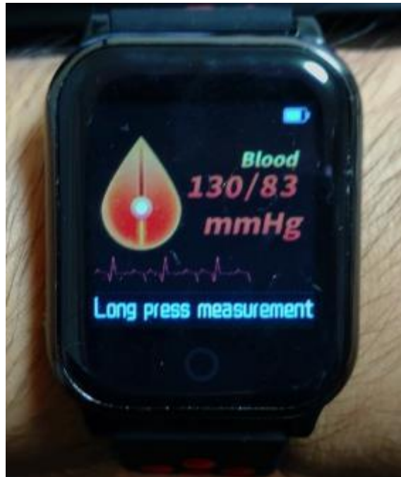
図 6-4 筆者が入手したカフレス血圧計機能をもつスマートウォッチ(メーカー不明)
