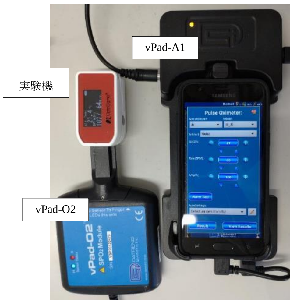
図 4-7 vPad-O2 と vPad-A1 にパルスオキシメータを装着した図
