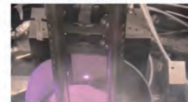
▲連続投入燃料へレーザーが照射された様子
