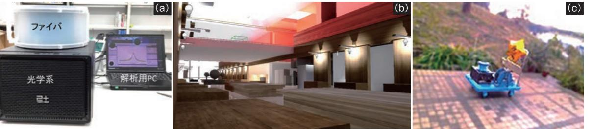
▲図2 (a)ブリルアン散乱を用いたセンサシステム、(b)作製した仮想現実への測定情報の反映(赤色部が異常部分を示す) (c) 野外測定システム
