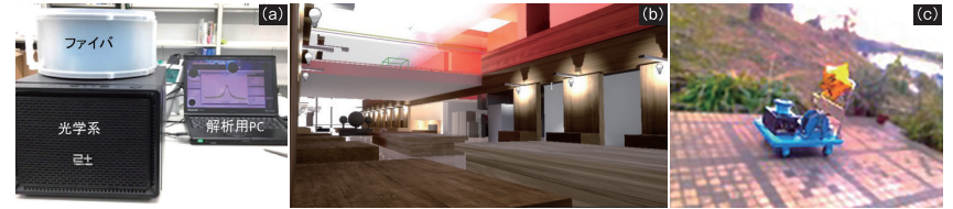
▲図2 (a)ブリルアン散乱を用いたセンサシステム, (b) 製作した仮想現実への測定情報の反映 (赤色部が異常部分を示す) (c) 野外測定システム
