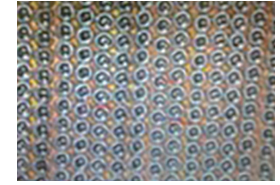
▲摺動特性改善を目的とした金属表面処理加工(局面へのディンプル形成)
